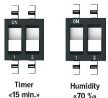
Ventilátor se automaticky zapne, když vestavěný senzor vlhkosti zjistí překročení **70 %** (viz ODDÍL 1), a bude pracovat, dokud senzor vlhkosti nezjistí pokles na **70 %** nebo niže (viz ODDÍL 1). Ventilátor pak poběží **15 minut** (viz ODDÍL 2) a vypne se.
