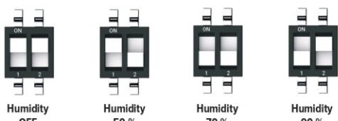
Pokud je čidlo vlhkosti vypnuto, ventilátor v automatickém režimu neběží. Ventilátor se zapne po připojení napájení a běží tak dlouho, dokud je napájení připojeno.
