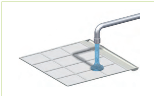
Obr. 17: Čištění vložnou vodou
